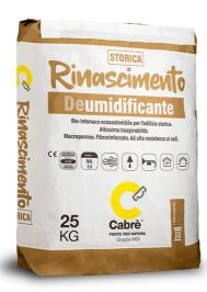
Intonaco fibrorinforzato deumidificante macroporoso, resistente ai sali, a base di Calce Idraulica Naturale NHL 3,5 a norma EN 459-1, per il risanamento ecosostenibile di tutte le tipologie di murature soggette ad umidità di risalita anche di pregio storico e per l'intonacatura di superfici site in ambienti aggressivi.
